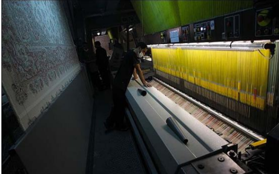
شکل ۲۴: نمونه دستگاه بافندگی فرش ماشینی
