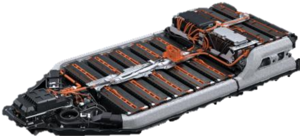
شکل ۴-۱، نمایی از جانمایی باتری در کف خودرو شرکت لکسوس
